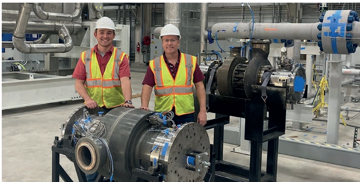
Figuur 4: de 16 MW sCO 2 turbine van het STEP project 25
