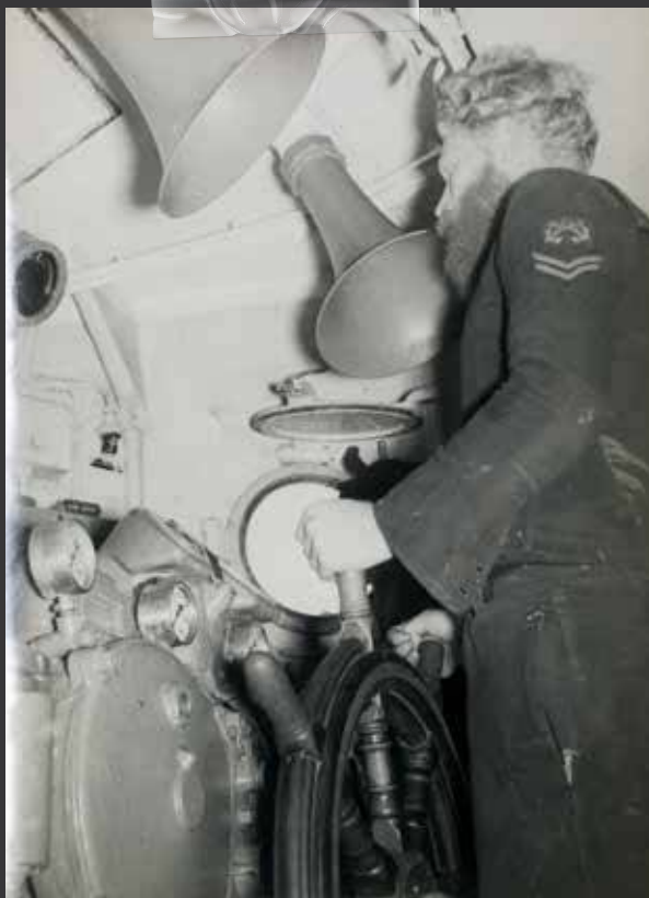
Blik op de roerganger. De twee trechters boven hem worden gebruikt voor communicatie met de brug.
