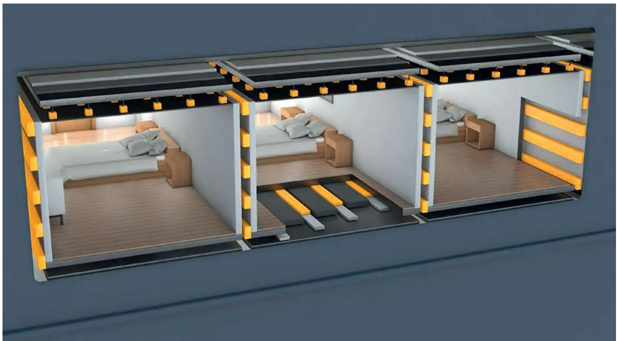
Box-in-box principe voor geluidsreductie
