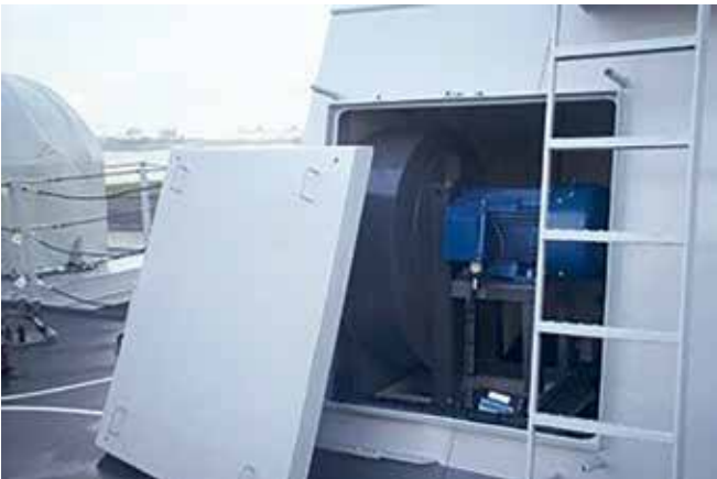
Afbeelding 1: Jet-X-box van een LCF met goed zichtbaar de ventilator die buitenlucht inblaast in de dieselmotoruitlaat
