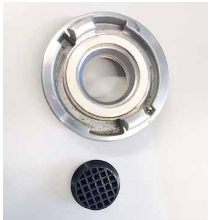
Rubber filter voor straalpijp, gemaakt met additive manufacturing (3D-printer). Niet meer te koop, maar essentieel tegen vervuild water eenmaal gedocked (eigen foto)
