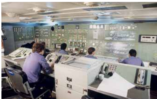
Technische centrale van een standaardfregat, met 'Decca Isis'-terminals en uitdraai op kettingpapier. (foto Beeldbank NIMH)
