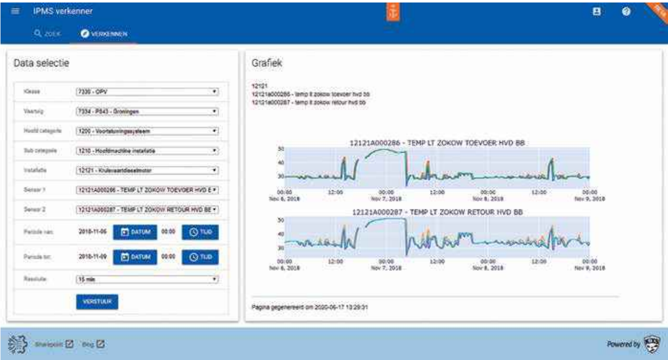
Twee methoden van data-analyse. Boven: foto's van dataschermen aan boord, samengevoegd met plakband. Onder: In de IPMS Verkenner zijn alle parameters over de gewenste periode tegen elkaar uit te zetten.
