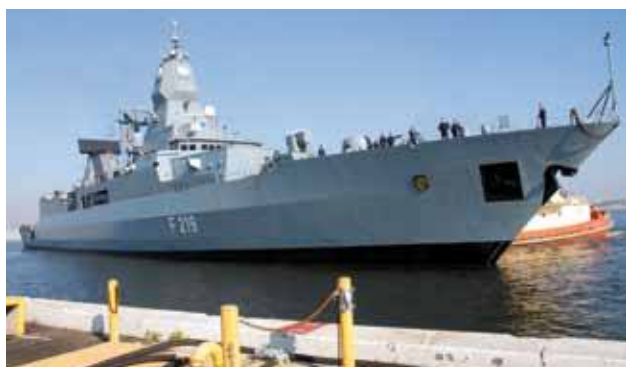
Duits luchtverdedigingsfregat van de F124 Sachsenklasse, uitgerust met hetzelfde AAW-systeem als de Nederlandse LCF. (foto wikipedia.org)
