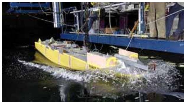
Proef met kapseizen, uitgevoerd bij het CRS (foto CRS)
