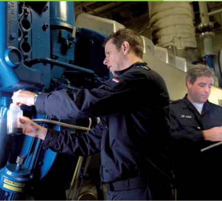
Figuur 3 Aftappen van een monster voor olieanalyse (bron: Bureau conditie en prestatiebewaking).
